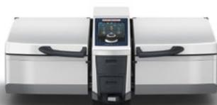
iVario, centre de cuisson multifonction pour pocher, sauter et frire. 2 cuves indépendantes, température réglable de 30°C à 250°C. iVario Control avec 7 groupes de process. Mode manuel : Pocher 30°C - température d'ébullition, rissoler 30°C à 250°C, frire 30°C à 180°C. Mode iVarioBoost: système breveté de chauffe dynamique en réseau pour une répartition totalement homogène et précise de la chaleur. Mode programmation: pour composer ses propres programmes et sauvegarder les process.
